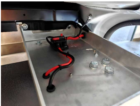
Positie smeltzekering (reset na overbelasting) op bovenplaat
