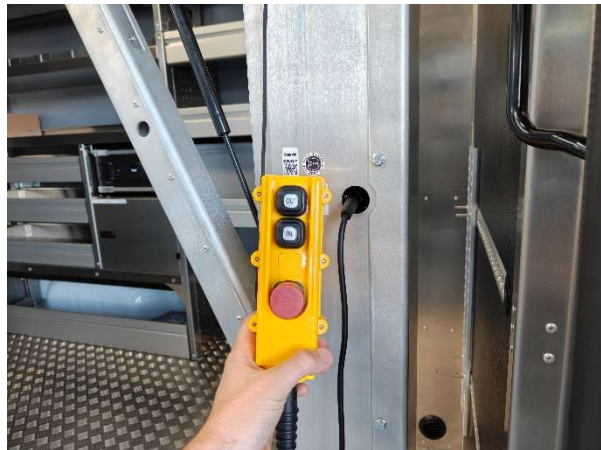
Bedrade afstandsbediening en positie connector in kolom
